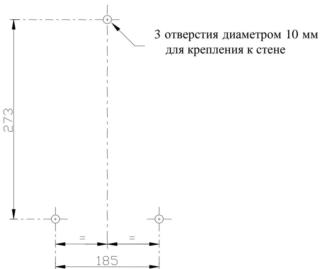
**Внимание: Крепление к стене должно обязательно производиться используя болты из нержавеющей стали.**
